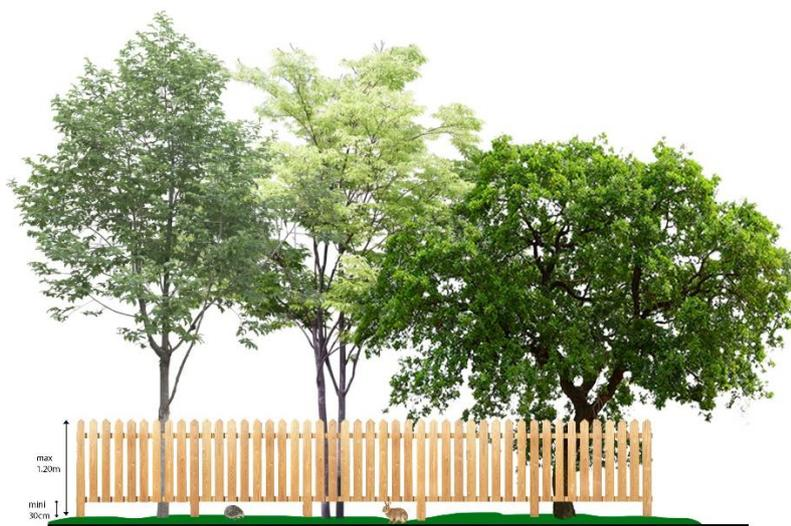
Figure 7 - Illustration d'une clôture permettant le passage de la petite faune (Terr&Am)
